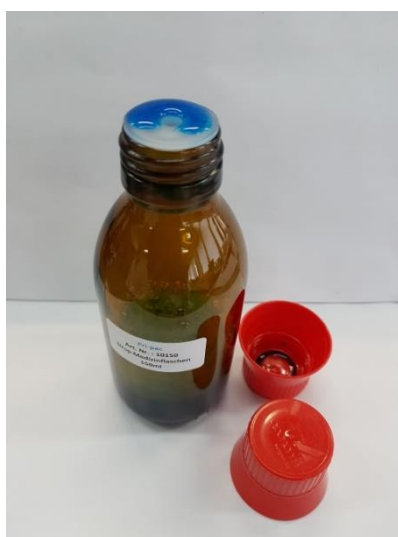
Abbildung 3: Ungeeignetes Verschlusssystem ohne Dichteinlage, Austritt der Prüflösung sichtbar
