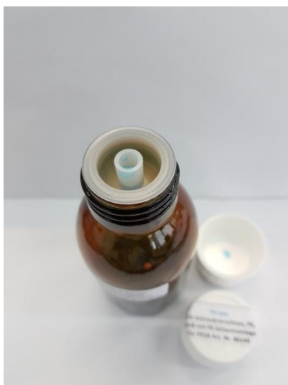
Abbildung 2: Geeignetes Verschlusssystem ohne Austritt der Prüflösung.
