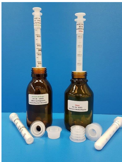
Abbildung 2: Zur Entnahme aufgesteckte und leere Kolbenpipetten ohne Konusspitze mit montierten und noch nicht montierten Steckversätzen.
